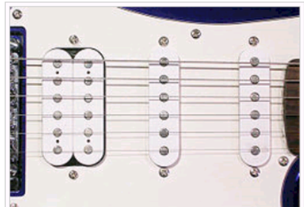
Elektromagnetische Tonabnehmer an einer E-Gitarre: ein Humbucker (links) und zwei Single Coils (mitte und rechts)
